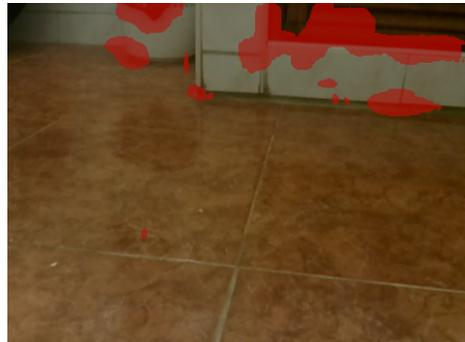
Figura 3.7: Detección de obstáculos mediante análisis de flujo óptico.
