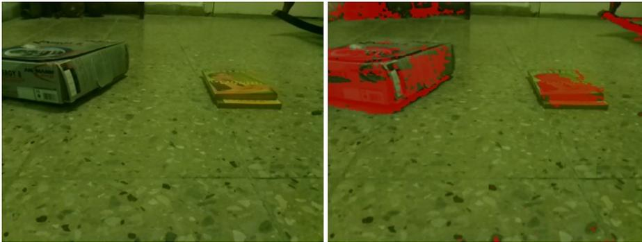
Figura 3.11: Detección de obstáculos mediante filtro de histogramas.
